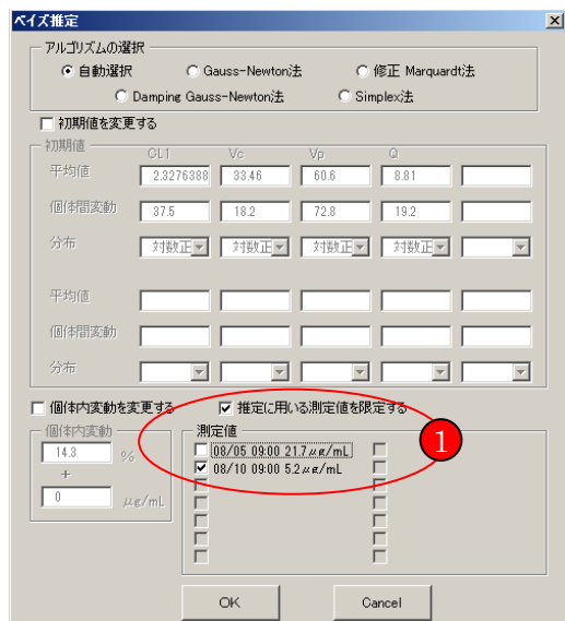
図 2-12 ベイズ推定画面の便利な使い方 推定に用いる測定値を限定することが出来る。
